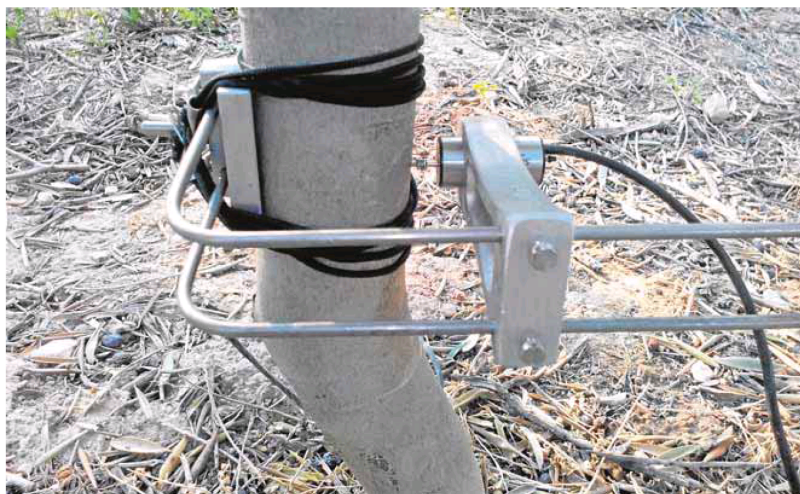
Dendrómetro midiendo las variaciones de grosor de un tronco para estimar sus necesidades hídricas. :: J. F. MAESTRE
